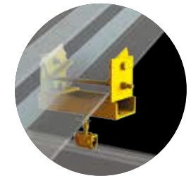
SCHRÄGE I-TRÄGERAUFHÄNGUNG SUSPENSION TO INCLINED I-GIRDER
