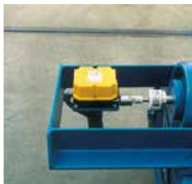
ENCODER + SPINDLE LIMIT SWITCH
